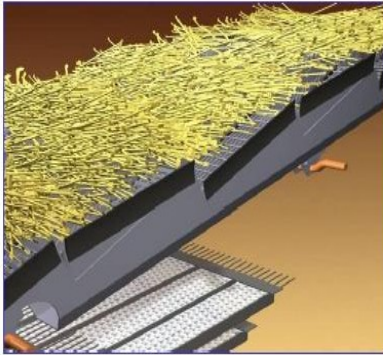
Şəkil 1.14 Samansilkələyənin texnoloji iş prosesi
