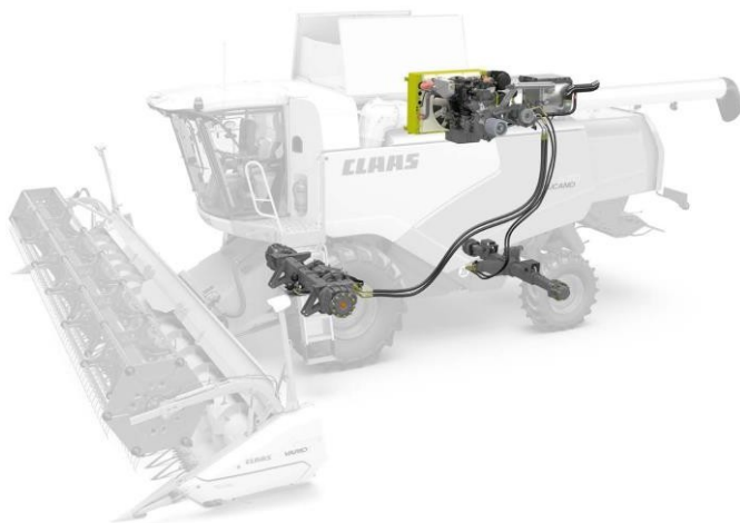
Şəkil 5.17 Hərəkət verən hidromühərrik
