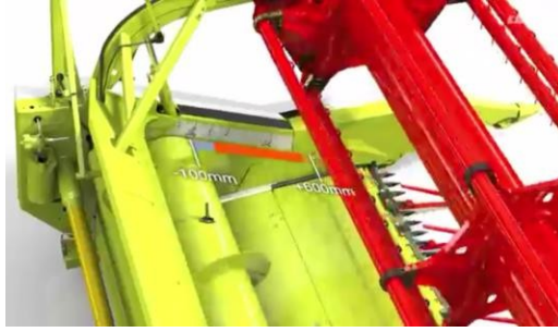
Şəkil 5.5 Seqmentli bıçaqların nizamlanması
