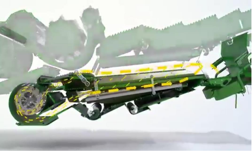
Şəkil 4.16 Ventilyatorun yaratdığı hava selinin istiqaməti
