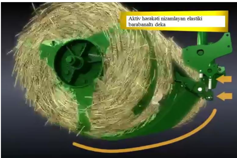
Şəkil 4.8 Baraban altı deka elastiki bağlayıcı qol ilə.
