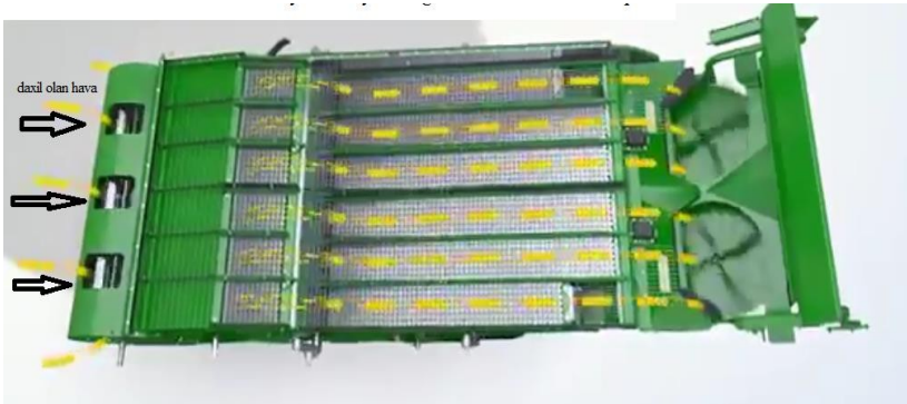
Şəkil 4.17 Ventilyatorun yaratdığı hava selinin istiqaməti
