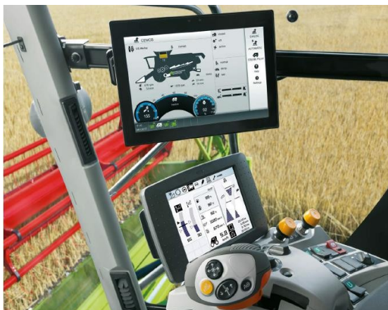
Şəkil 5.24 İdarəetmə kabinəsində idarəetmə elementləri
