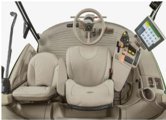
Şəkil 4.21 İdarəetmə kabinəsi
