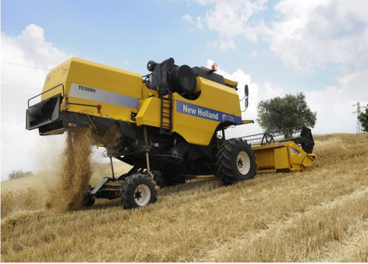
Şəkil 1.17 Özü-özünü tarazlayan hidravliki sistemli kombayn
