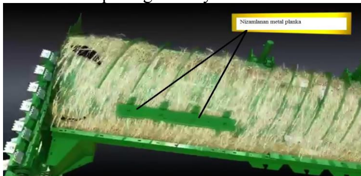
Şəkil 4.14 Rotor üzərində olan nizamlanan plankalar
