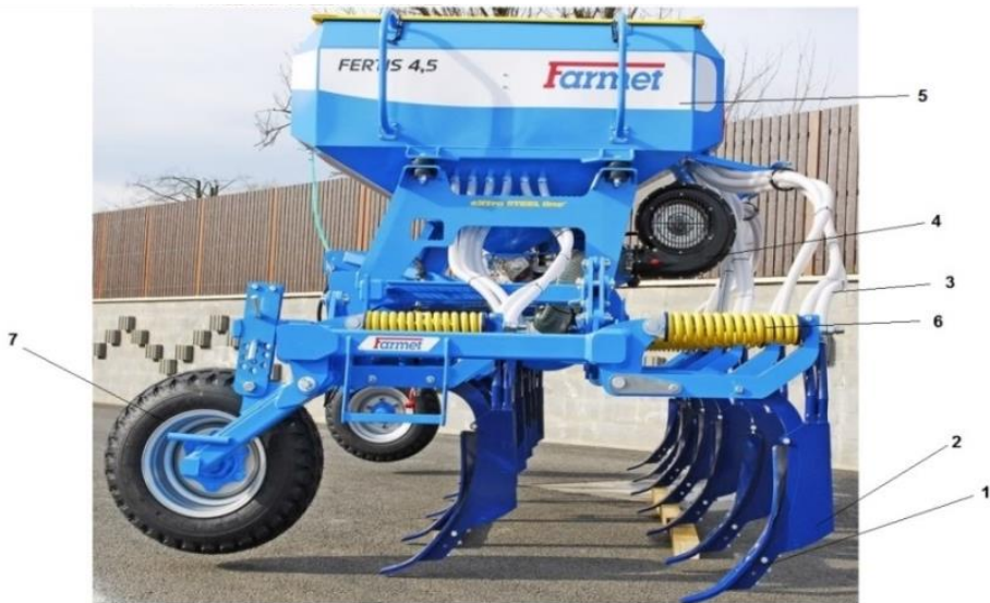
Şəkil 1.5. Fertis-4,5 torpaq becərən gübrələyən maşın 1 – ripər, 2 – gübrə tökülən çıxış, 3 – axın gübrə borusu, 4 – pnevmatik mühərrik, 5 – gübrə bunker, 6 – elastik yay, 7 –dərinliyi nizamlayan dayaq təkəri
