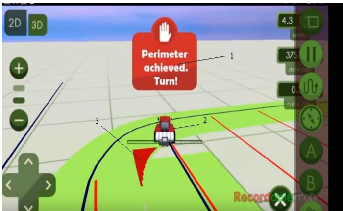
Şəkil 5.18 Naviqatorda əks olunan göstəricilər 1 – sürümün sonunu göstərir, 2 – aqreqat, 3 – təkrarlanan əməliyyat
