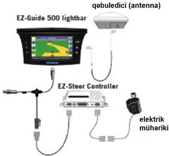
Şəkil 5.3 Autopilot Motor Drive ® - qurulma sxemi
