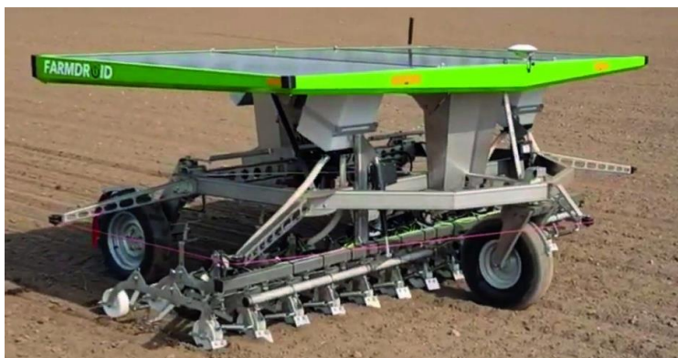
Şəkil 3.9 Toxum və gübrə səpən FD 20 aqrobotu
