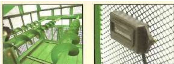
Şəkil 6 Təchizat şneki 3 ədəd və nəzarət datçiki
