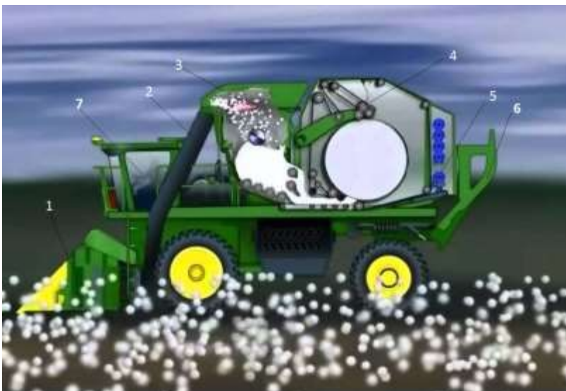
Şəkil 1.4 Pambıq yığan kombaynın texnoloji sxemi.
