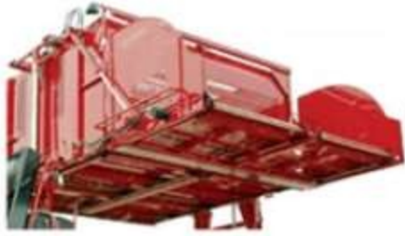
Şəkil 9.13 Pambığı boşaldan bunker və mexanizmi
