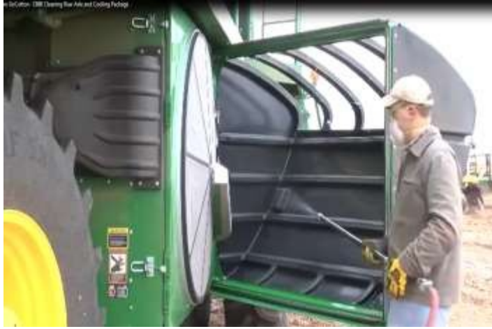
Şəkil 2.9 Hava süzgəcinin təmizlənməsi
