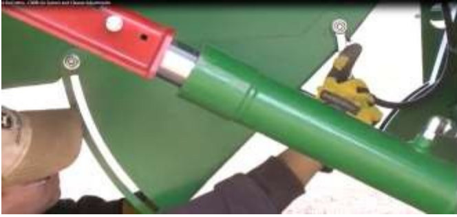
Şəkil 1.35 Pnevmatik boruda nizamlanan ling
